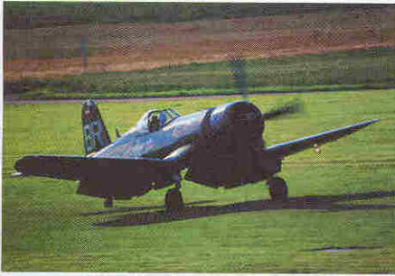
Die Corsair beim Ausrollen. Beachte den ausgeklappten Landescheinwerfer.
