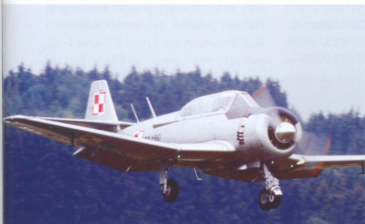
■ PZL TS-8 Bies SP-YBD aus Polen, ehemaliges Schulflugzeug mit einem WN-2 Sternmotor, ein echt seltenes Stück ■
