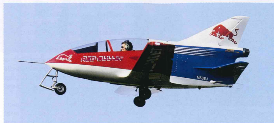
Das kleinste Strahlflugzeug der Welt: die einsitzige Bede BD 5-J. Das Fahrwerk braucht nur eine Sekunde zum Ein- oder Ausfahren.
