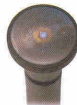
Lycoming Ventilstößel nach 300 Betriebsstunden mit Exxon Elite 20W-50 – praktisch kein Lochfraß.
