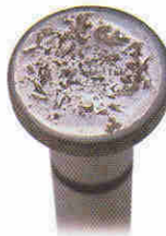
Lycoming Ventilstößel nach 180 Betriebsstunden mit Mehrbereichs-Mineralöl 20W-50 eines Konkurrenten.
