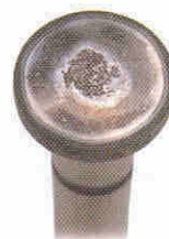
Lycoming Ventilstößel nach 240 Betriebsstunden mit teilsynthetischem Mehrbereichsöl 15W-50 eines Konkurrenten.
