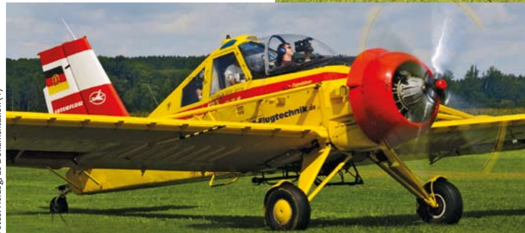
DIETER GEHLING mit PZL-106: Wenn nicht gerade der Himmel seine Schleusen über Tannheim öffnet, wird Dieter Gehling aus Stadtlohn mit seiner „Kruk“ Feuerlöscheinsätze demonstrieren. Bei dieser Kruk handelt es sich um eine Sonderausführung des Agrarflugzeuges. Der Chemikaliertank ist verkleinert worden, um Platz für ein zweites Cockpit zu schaffen. So konnten Piloten geschult werden.
