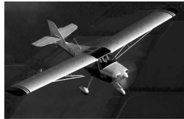
EUROFOX 160 km/h Reisegeschwindigkeit F-Schlepp bis 750 kg
