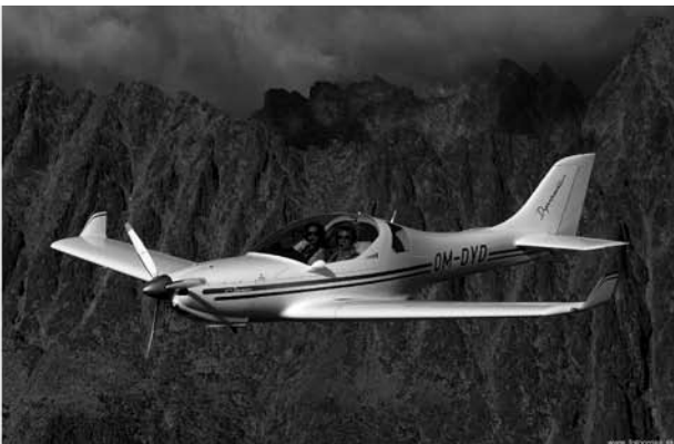
DYNAMIC 230 km/h Reisegeschwindigkeit F-Schlepp bis 750 kg, Banner bis 200 m 2
